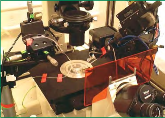
Appareil utilisé lors de l'enregistrement des minuscules changements de voltage qui ont lieu dans la synapse.
